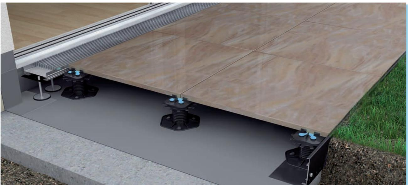
Ein perfektes Duo bildet die Drain-Kiesleiste mit dem Trocken-Stelzlager TerraMaxxTSL. Es ist ebenfalls ohne Werkzeug stufenlos höhenverstellbar und bis 9 Prozent nivellierfähig. Das erleichtert die Ausrichtung des Belages bei kleineren Unebenheiten im Untergrund.
