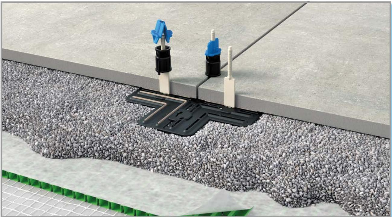
Das System besteht aus einer Fixierplatte und dem Nivelliersystem IndorTec FN-XT. Die kreuzförmige Fixierplatte ist so konzipiert, dass sie sich im Kies- oder Splittbett verankert und so horizontale Bewegungen verhindert. Mit dem Montagekleber DiProtec FIX MSP wird der Belag anschließend auf der Fixierplatte befestigt und mithilfe des Nivelliersystems IndorTec FN-XT auf ein einheitliches Niveau ausgerichtet.
