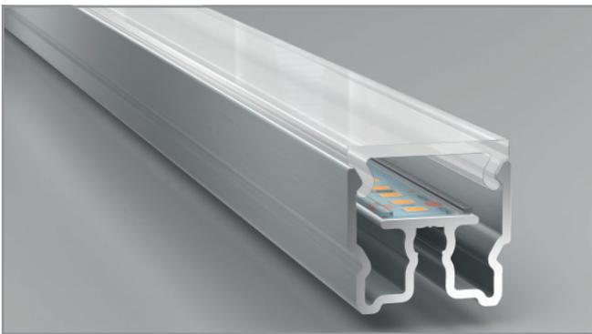
Eine weitere Besonderheit von TerraMaxx ACCENT ist der konstruktive Schutz vor Feuchtigkeit. Das Profil ist so aufgebaut, dass die LED-Stripes erhöht sitzen. Zusätzlich gibt es an den Seiten jeweils einen Drainkanal, der eindringendes Wasser abführt.
