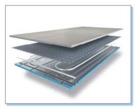
Wie flexibel die Einsatzmöglichkeiten inzwischen sind, zeigt die Warmwasser-Fußbodenheizung IndorTec THERM-W von Gutjahr. Die Heizung kann direkt unter dem Belag eingebaut werden. Estrich ist – anders als bei vielen herkömmlichen Fußbodenheizungen – nicht erforderlich.
