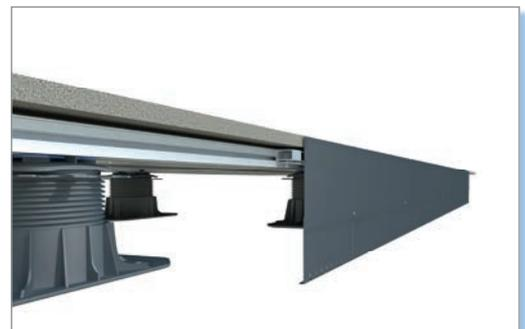
**ProFin RS** und **ProFin RS-H** sind klassische Randprofile aus pulverbeschichtetem Aluminium, die direkt am Alu-Rahmensystem befestigt werden. Es gibt zwei Varianten: ProFin RS hat eine feste Höhe von 170 mm, ProFin RS-H hat zusätzlich eine höhen- und neigungsverstellbare Verlängerungsblende.
