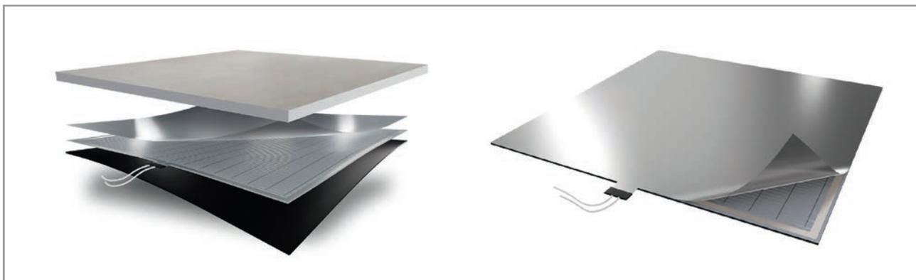
Die elektrischen TerraMaxx COMFORT Heizmodule sind selbstklebend – sie können einfach auf der Rückseite des Plattenbelages aufgebracht werden. An diesen Stellen werden die Beläge dann erwärmt. Die Heizfolie liefert immer nur so viel Energie, wie benötigt wird. Zudem reguliert sie sich selbst, um die Temperatur konstant auf 24 Grad Celsius zu halten. Das optimiert den Energieverbrauch.
