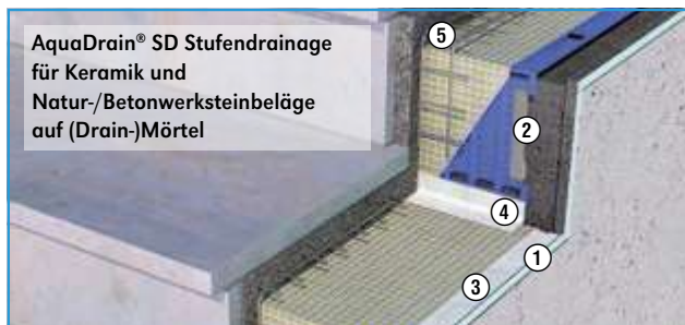
AquaDrain® SD Stufendrainage für Keramik und Natursteinbeläge im Mittelbett
