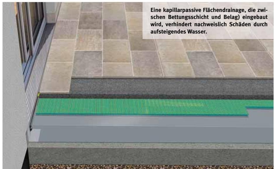
Eine kapillarpassive Flächendrainage, die zwischen Bettungsschicht und Belag eingebaut wird, verhindert nachweislich Schäden durch aufsteigendes Wasser.
