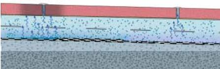
Wasser gelangt über die Fugen in die Konstruktion. Wenn es sich staut, z.B. an Unebenheiten der Balkonplatte oder des bindigen Untergrundes, wird es über die Bettungsschicht an die Oberfläche zurücktransportiert. Die Folgen: Ausblühungen, Frostschäden und Feuchtflecken.
