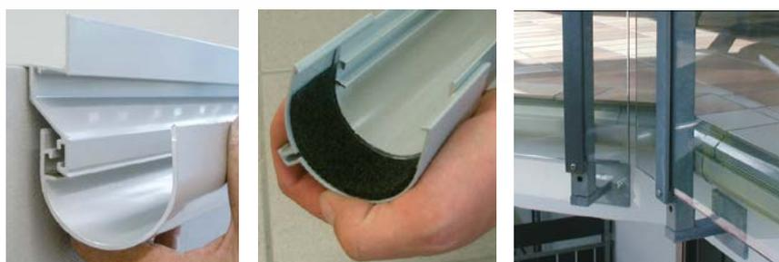
Il sistema di canali ProRin® si aggancia semplicemente nelle cavità apposite dei profili GUTJAHR assicurandolo con delle clips. Con gli elementi di raccordo ProRin® si uniscono in modo semplice, veloce e sicuro i canali. Non servono saldature e colle. Le dimensioni compatte del sistema garantiscono il montaggio anche in passaggi ristretti tra le strutture dei balconi e i montanti delle ringhiere. ProRin® BR è un sistema versatile e completo sia per il drenaggio con pluviali che con doccioni.
